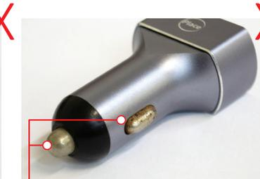
Sinais de oxidação devido ao contato com umidade
