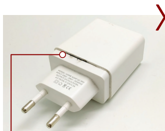
Sinais de fuligem/carbonização causados por surto de tensão na rede elétrica
