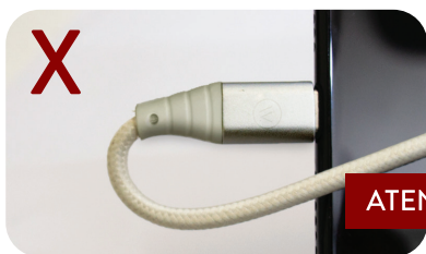
Torção do cabo. Isso pode causar a quebra dos componentes internos e pequenos curtos.
