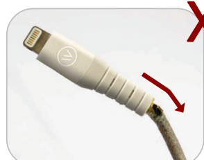
Torção do cabo. Isso pode causar a quebra dos componentes internos e pequenos curtos.
